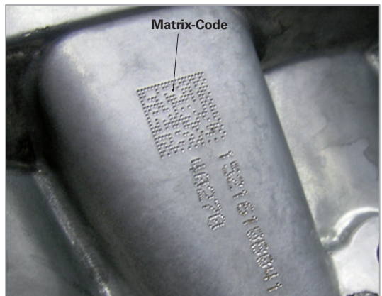
Bild 2: Matrix-Code auf Gussteil
