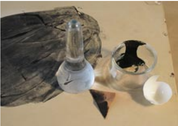
6 | Herstellung von Zeichentusche aus Lederruß und Eikläre.
