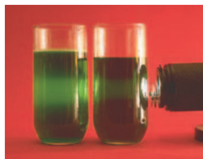
Abbildung 13.20: Tyndalleffekt im Labor. Das Glas links enthält eine kolloidale Dispersion, das rechts enthält eine Lösung. Der Weg des Strahls durch die kolloidale Dispersion ist sichtbar, weil das Licht von den Kolloidteilchen gestreut wird. Licht wird nicht von den gelösten Teilchen gestreut.
