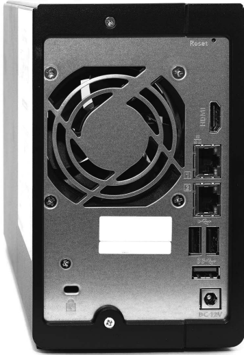
Abb. 1.2: Dieses Modell weist eine HDMI-Schnittstelle, zwei RJ45-Anschlüsse, 2 USB- und einen USB-3.0-Anschluss auf.
