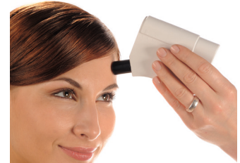
Die Sonde des Sebumeters wird für 10–30 Sek. auf die Haut gedrückt.
