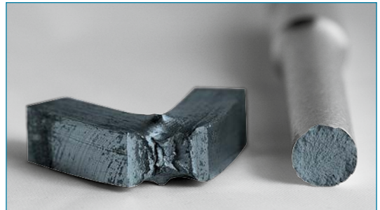
Bild 3: Vergleich von Zähbruch (links) und Spröbruch (rechts)
