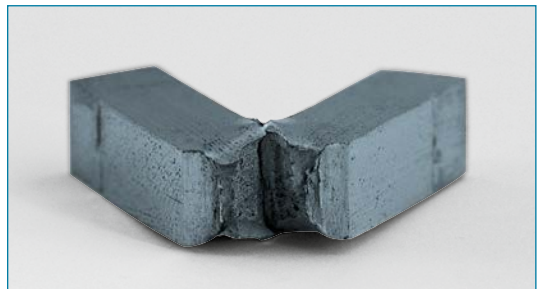
Bild 3: Kerbschlagprobe nach dem Versuch
