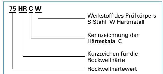
Bild 2: Normgerechte Angabe eines Rockwell-Härtewertes (Beispiel)
