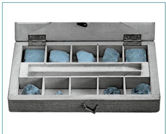
Bild 2: Härteskala nach Mohs
