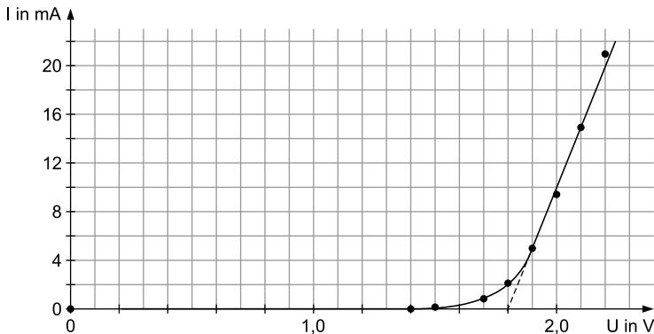
Die Schleusenspannung  $U_S$  beträgt ca. 1,8 V.
