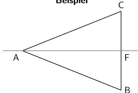
**2. Schritt:** Von jedem Punkt der Grundfläche, der ober- bzw. unterhalb der Schrägbildachse liegt, fällt man das Lot auf die Schrägbildachse.
