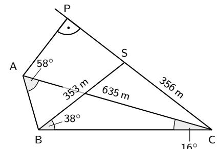
Hierfür wird das Maß des Winkels PCA benötigt. Dieses wird mithilfe des Winkelmaßes  $\angle SCB$  bestimmt, welches wiederum mithilfe des Sinussatzes im Dreieck BCS bestimmt wird:
