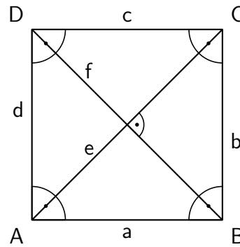
**Parallelogramm**Es gilt:  $a = c$ ,  $b = d$  und  $\alpha = \gamma$ ,  $\beta = \delta$ Umfang:  $U = 2 \cdot (a + b)$ Flächeninhalt:  $A = a \cdot h_a = b \cdot h_b$
