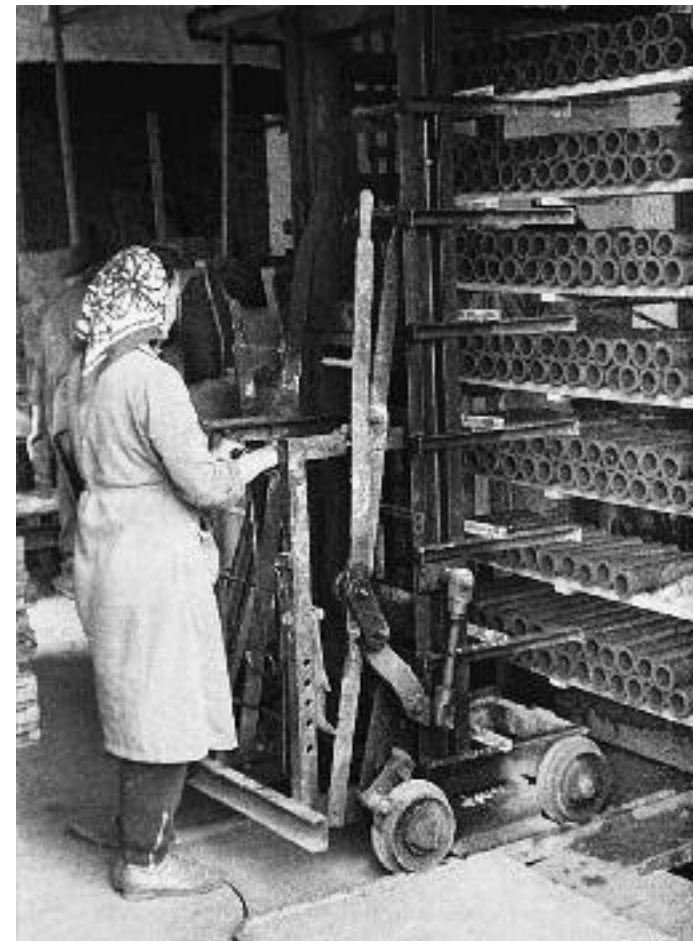
ABB. 368 Ziegelei ③⑤, Drainrohrproduktion, Abfuhr der Drainrohrformlinge am Senkrechtförderer mittels Absetzwagen (Foto 1960).
