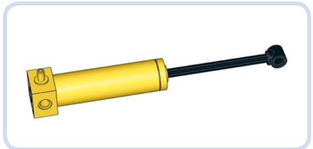
Bei diesem Zylinder handelt es sich im Grunde genommen nur um eine verlängerte Version des mittelgroßen Zylinders aus dem alten System. Er verfügt über einen einzelnen Anschluss und über einen Kolben, der 6 Noppen weit ausgefahren werden kann. Wegen des Plastikkolbens und der großen Ausfahrlänge kann er unter Last schneller brechen als jeder andere Zylinder.
