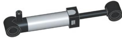
Diese 2011 eingeführte Pumpe soll die 5,5L-Pumpe ersetzen und ist bis auf die Länge mit ihr identisch. Der Kolben fährt ebenfalls 2 Noppen weit aus, aber da der Abstand zwischen Boden und Spitze jetzt volle 6 Noppen beträgt und es keinen Versatz um eine halbe Noppe mehr gibt, lässt sie sich leichter verwenden. Trotz der vergrößerten Länge sind Pumpvolumen und Effizienz gegenüber der 5,5L-Version unverändert. Es gibt diese Pumpe nur in Hellgrau.
