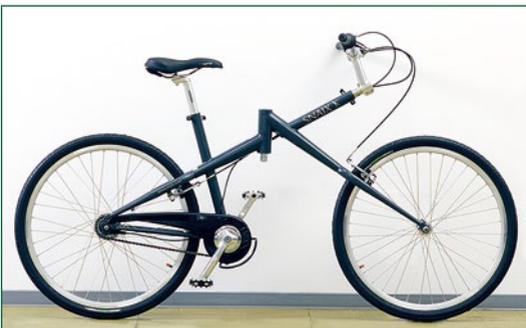
**Bild 2:** Knicklenker-Sattelfahrrad, Snaix
