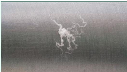
**Bild 2: Filiformkorrosion**
