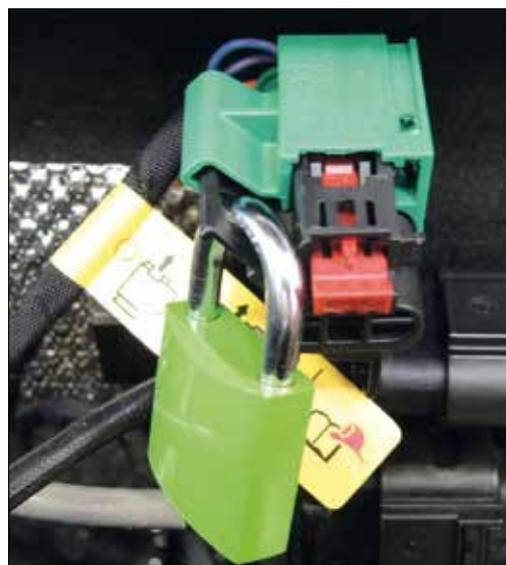
Bild 19: Niedervolt-Freischalt-Stecker eines VW Passat GTE, der mit einem Schloss gegen Wiedereinschalten gesichert ist.
