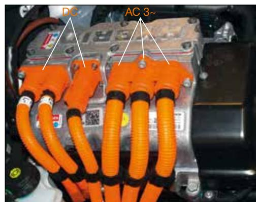
Bild 07: Inverter VW Passat GTE
