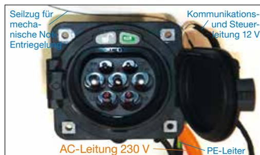
Bild 11: Ladesteckdose (AC) Typ 2 eines Mercedes S 500 Plug-In Hybrid: einphasiges Laden 3,7 kW
