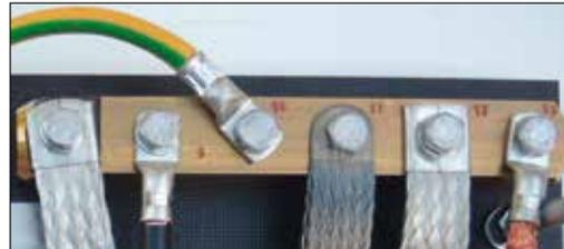
Bild 17: Messing Potenzialverteiler zur Aufnahme der Masseleitungen unterschiedlicher HV-Geräte
