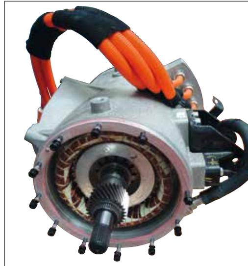
Bild 09: 100-kW-Asynchron-Drehstrom-Maschine eines Hyundai ix35 Fuel Cell
