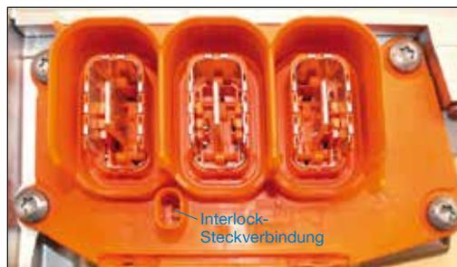
Bild 16: HV-Drehstrom-Steckverbinder am Inverter eines Renault Kangoo Z.E. oder ZOE
