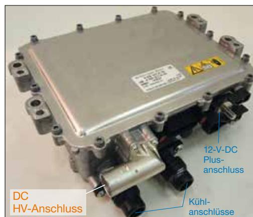
Bild 08: DC/DC-Wandler Mercedes 350e Plug-In Hybrid
