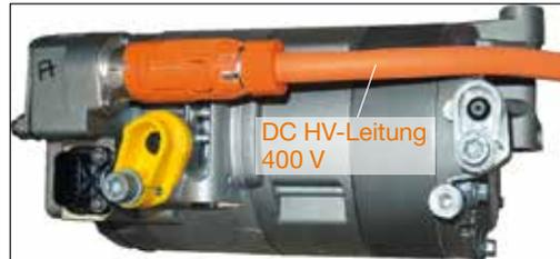
Bild 12: Sanden HV-Klimakompressor eines BMW i8
