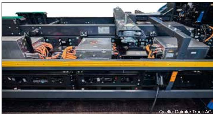
Bild 04: eActros in der gleichen Blickrichtung wie Bild 03. Hier kann man gut die HV-Leitungen und Kabel-Verschraubungen an den HV-Bauteilen erkennen
