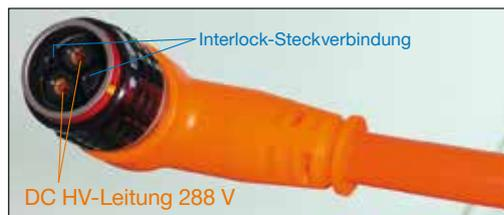
Bild 15: HV-Leitung mit Rundstecker und HV-Interlock für einen Porsche Cayenne Inverter
