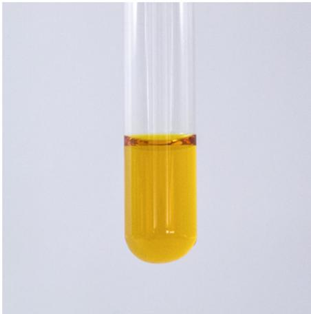
Abb. 14.5 Tetraiodidobismutatkomplex [BiI<sub>4</sub>]<sup>-</sup>
